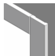
VERZIA C 90° lišty 80 mm, pojené pod uhlom 90° (zárubne DIN verzia B, DIN DUO)
